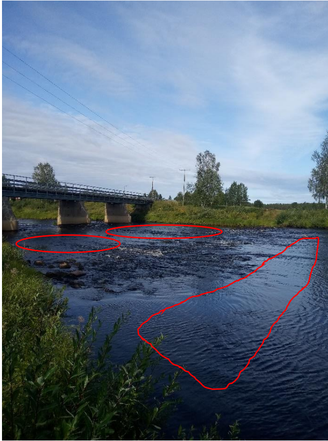
Kuva 34. Kohta 1 ja 2. Niskalle 200 tonnia kutusoraa/poikaskiveä, molempiin alempiin alueisiin 80 tn soraa/poikaskiveä = 160 tn. Kovaan virtaan tulisi myös saada muutama isompi lohkarer ohjaamaan virtaa.
